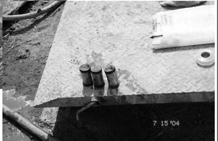
➡ 標準貫入試驗所取得之銅圈樣品
